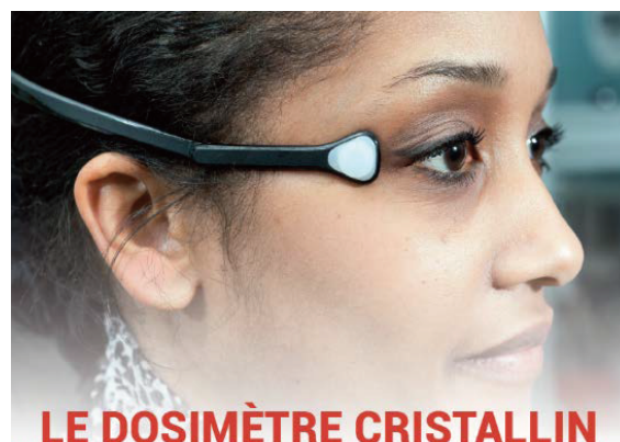
図 3 水晶体用線量計 (フランス放射線防護原子力安全研究所パンフレットより引用)
